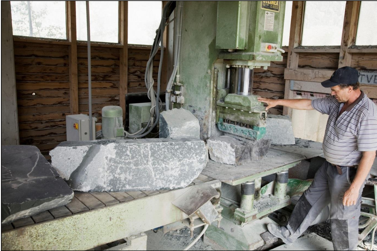
Abb. 131: Steinspaltmaschine im Steinbruch Unterklien zur Herstellung von Mauersteinen
