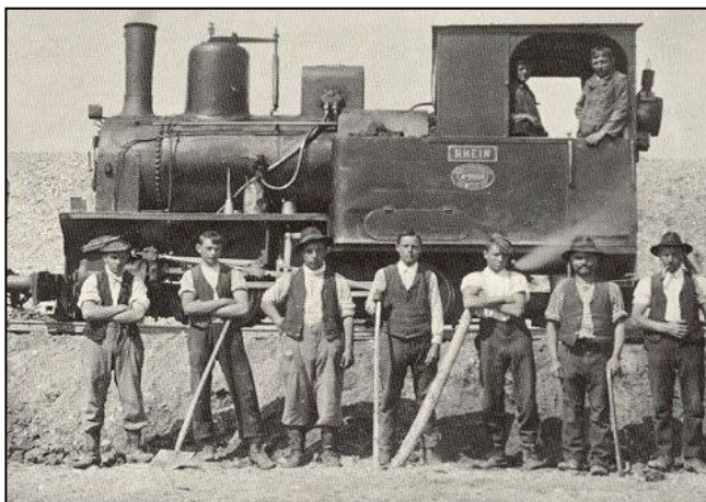
Abb. 19: Die "Rhein" Dampflokomotive: 75 PS, 750 mm Spurweite, 14,5 t Dienstgewicht
