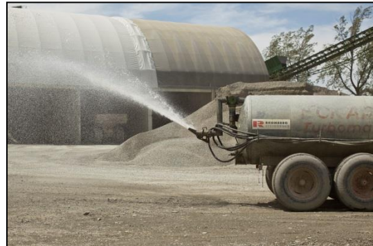
Abb. 133: Durch die laufende Bewässerungen der Fahrstraßen bei Trockenheit wird die Staubentwicklung durch Verkehr im Steinbruch stark reduziert.
