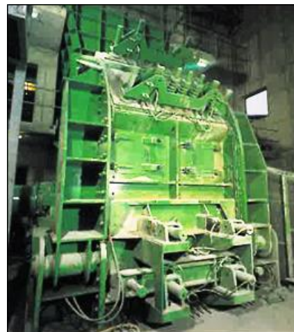
Abb. 81: Hazemag Primär Prallbrecher Type APPM 2022 Aufgabeleistung: 800 t/h
