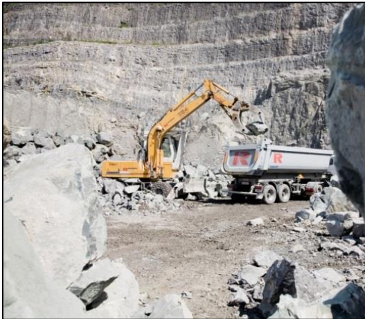
Abb. 135: Gewinnung von Wasserbausteinen, zum Einsatz gelangen diese vor allem beim Hochwasserschutz.
