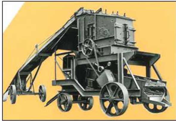
Abb. 46: Prallbrecher aus dem Jahr 1957 der Fa. Hazemag
