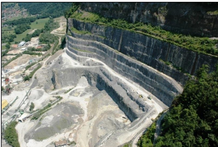
Abb. 129: Einblick in die gesamte Steinbruchwand mit den einzelnen Etagen und den bereits rekultivierten Anlagen auf der obersten Etage im Bereich der „Neuen Welt“
