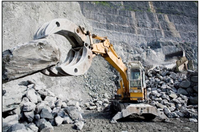
Abb. 135: Gewinnung von Wasserbausteinen, zum Einsatz gelangen diese vor allem beim Hochwasserschutz.
